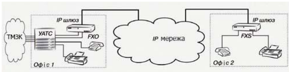
Рис. 1.1. Загальний принцип дії телефонних шлюзів IP-телефонії
