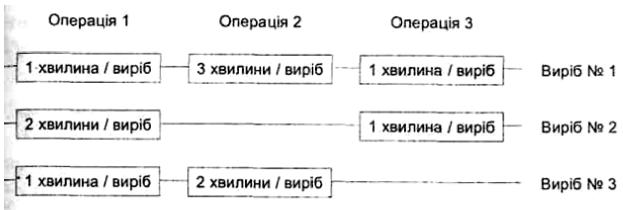
Рис. 10.2. Технологічна схема виробництва виробів
