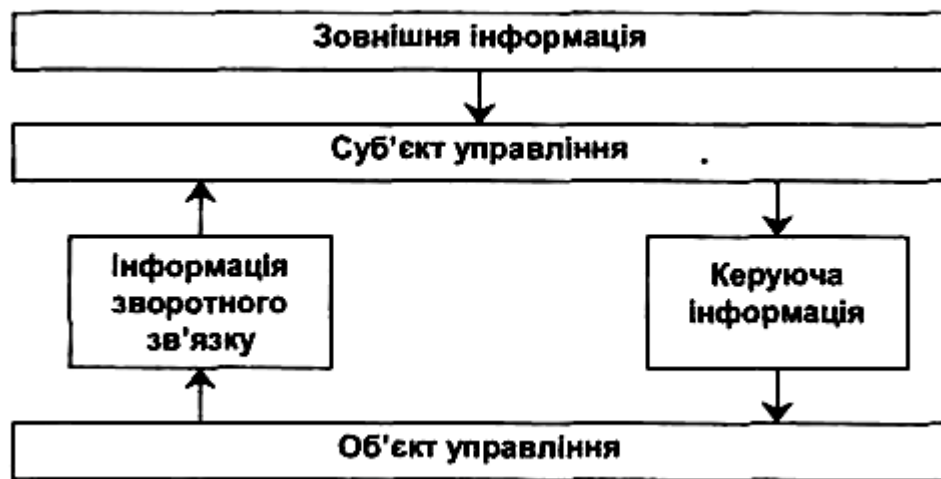
Рис. 10.3. Схема кібернетичного контуру управління зі зворотним зв'язком
