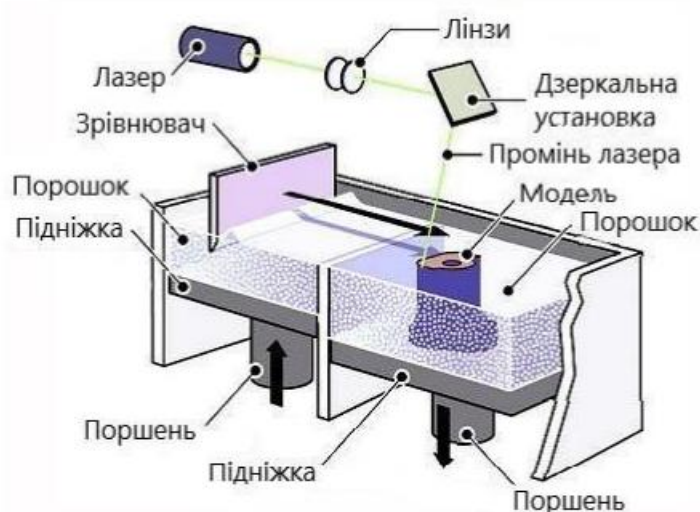
Рис.1.3. Процес створення прототипів за допомогою технології селективного лазерного запікання
