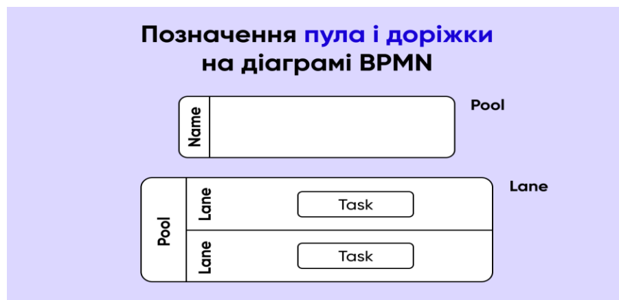
Рис.1.4. Призначення пула і доріжки на діаграмі BPMN.
