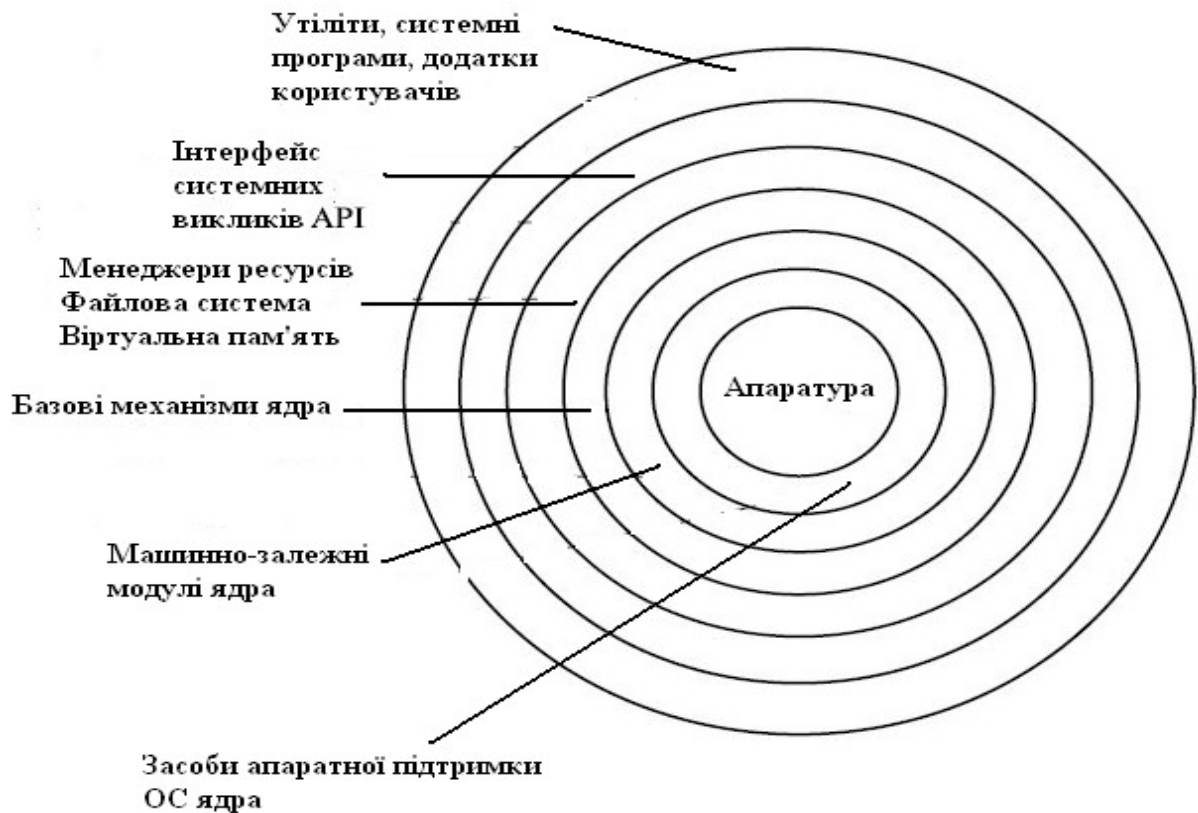
Рис. 1.5. Багатошарова структура ОС
