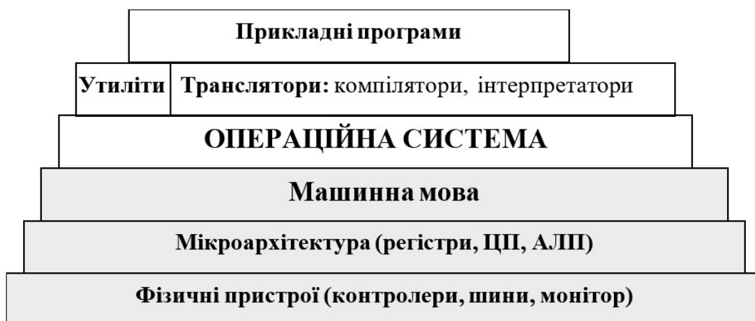
Рис. 1.2. Ієрархічна структура програмно-апаратних засобів комп'ютера:
