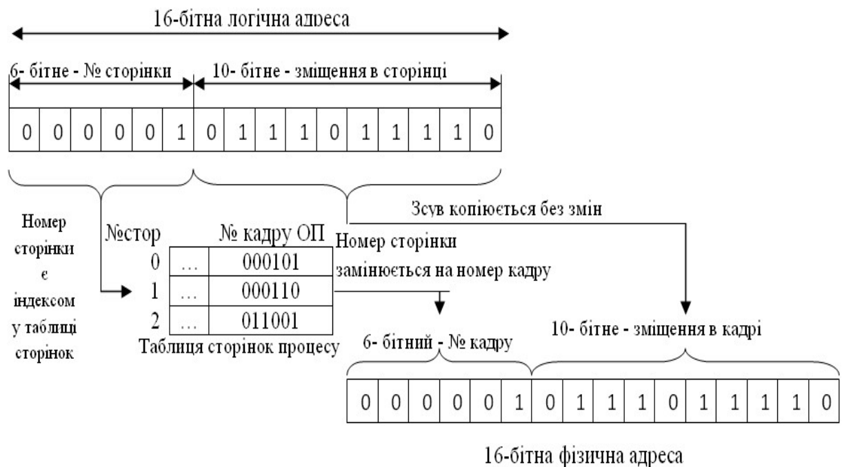
Рис. 3.5. Приклад трансляції логічних адрес у фізичну адресу у разі сторінкової організації пам'яті
