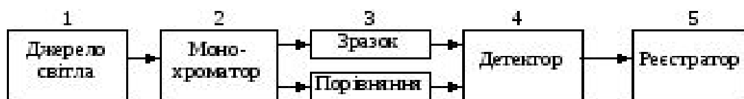
Рисунок 6.7 – Принципова схема молекулярно-абсорбційного приладу
