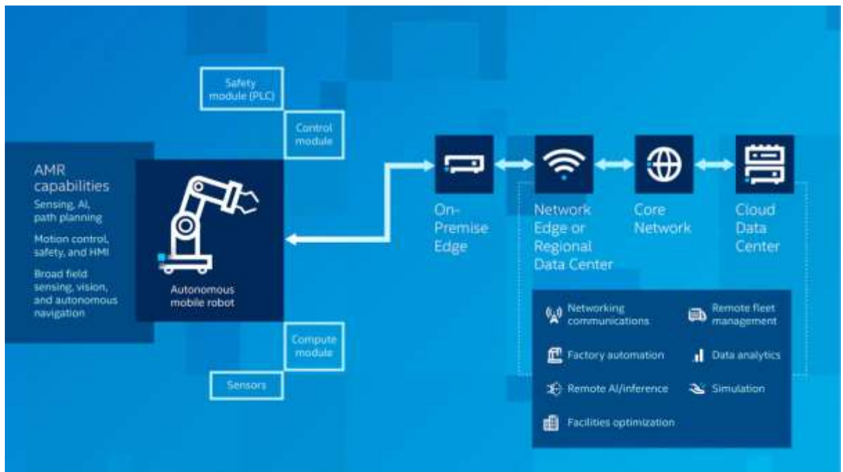
Рис. 2.3. Компоненти та архітектура автономного мобільного робота типу АКТС
