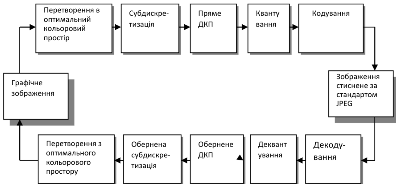
Рис.1.2. Етапи стиснення цифрових зображень за алгоритмом JPEG (складено за [26])
