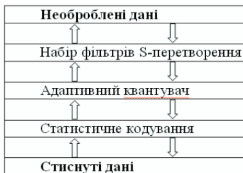
Рис. 1.3. Схема хвильового кодування [28]
