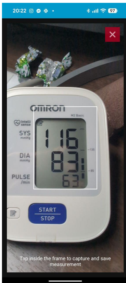
Рис.2.1 Екран камери смартфона з накладеною графічною рамкою фокусування (ROI) під час розпізнавання показників з дисплея тонометра Omron
