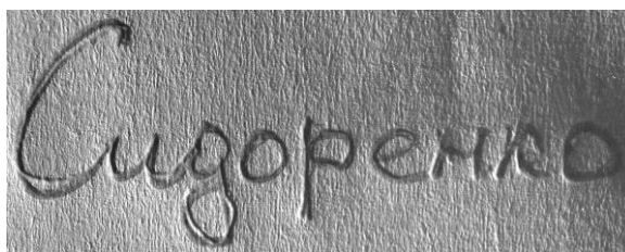
Рис. 3. Збільшене зображення короткого рукописного запису, виконаного за допомогою олівця з наступним обведенням штрихів барвником синього кольору, при кососпрямованому інфрачервоному (ІЧ) освітленні.
