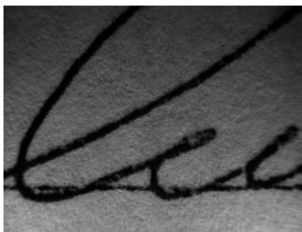
Рис. 26. Збільшене зображення фрагмента підпису, виконаного електрофотографічним способом друку, при кососпрямованому інфрачервоному (ІЧ) освітленні.
