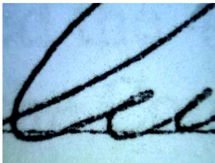
Рис. 25. Збільшене зображення фрагмента підпису, виконаного електрофотографічним способом друку, при кососпрямованому освітленні у видимій області спектру.
