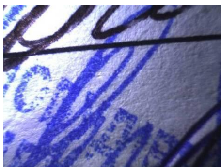
Рис. 21. Збільшене зображення підпису, нанесеного за допомогою кліше-факсиміле.
