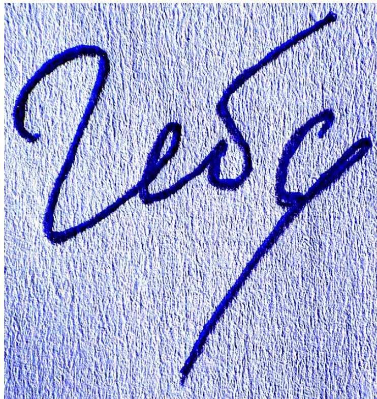
Рис. 5. Збільшене зображення підпису, виконаного за допомогою копіювання через копіювальний папір (фіолетового кольору) з наступним обведенням штрихів, при кососпрямованому освітленні у видимій області спектру.
