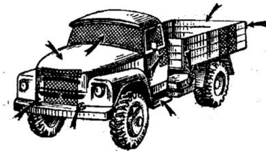
Рисунок 1.39 – Основні ділянки автомобільної техніки, які підлягають частковій дегазації
